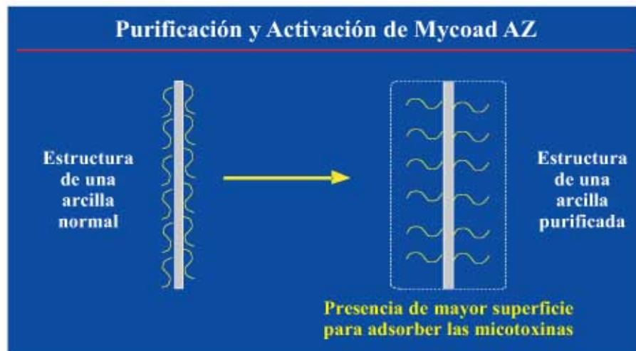
Figura 2. Representación gráfica del efecto de purificación sobre la adsorción de micotoxinas.
