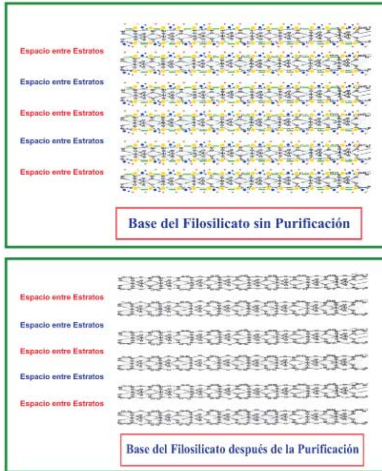
Figura 1. Apariencia estructural de un filossilicato (arcilla) antes y después de la purificación.
